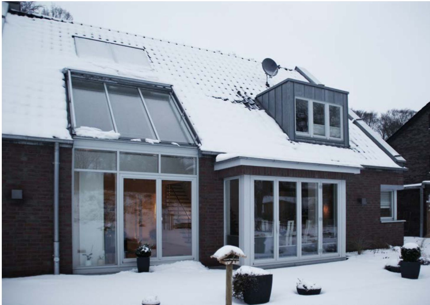
Projekt: Neubau eines Einfamilienhauses mit Wintergarten Ausführung: Holzfenster und -türen System IV 68, Meranti 450 kg+ Besonderheiten: Dachverglasung aus Holz-Alu mit Beschattung Bundesland: Hamburg
